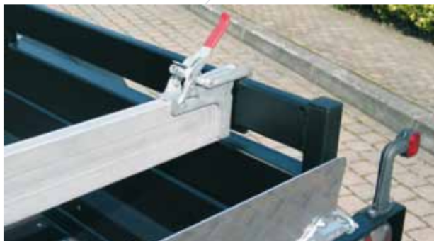
Rampe additionnelle pour fixer les séparations
