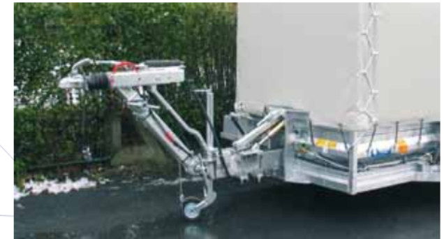
Timon réglable Hauteur max. 1100 mm.
