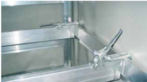
Barre de fret pour stabiliser le chargement
