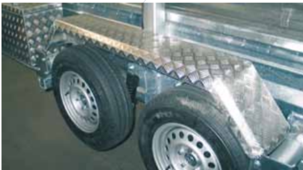
Garde-boue avec finition spéciale en aluminium
