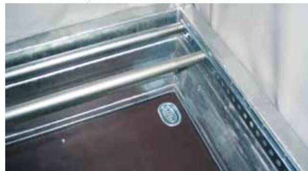
Rail perforé avec barre de fret télescopique et anneau
