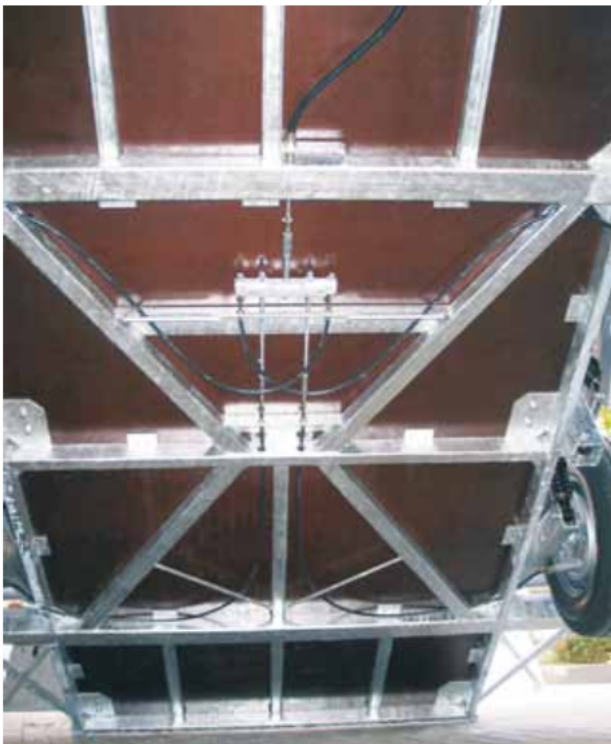
Châssis PT35 revêtu d'un plancher bois multicouche
