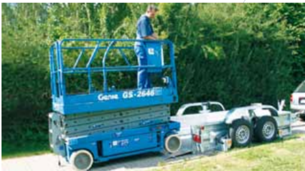
Chargement rapide d'une nacelle
