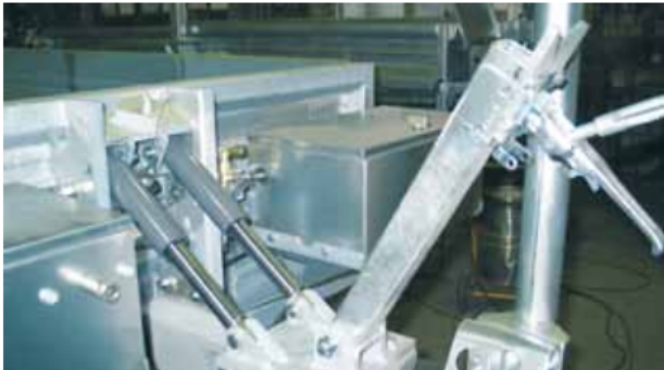
Levier de sécurité lors de l'abaissement du plateau
