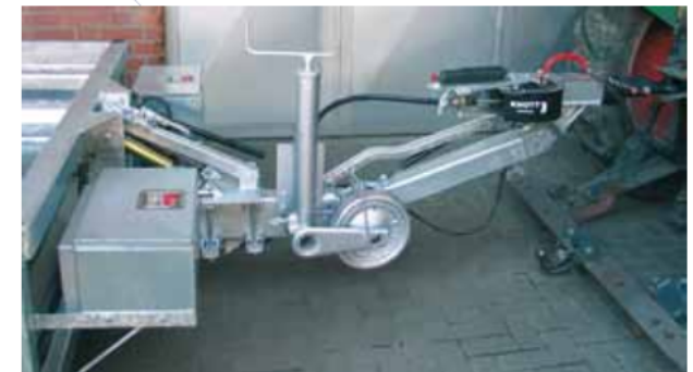
Timon réglable en hauteur avec anneau DIN et roue jockey
