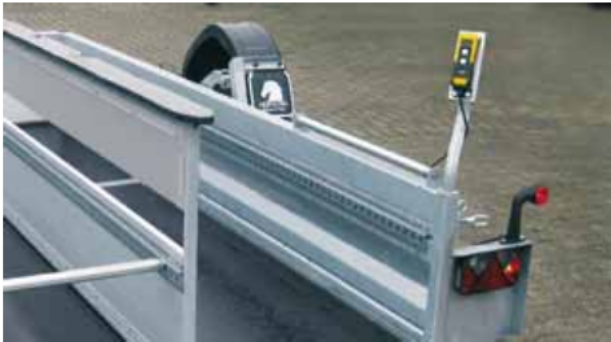
Commande pour pompe hydro-électrique située à l'arrière
