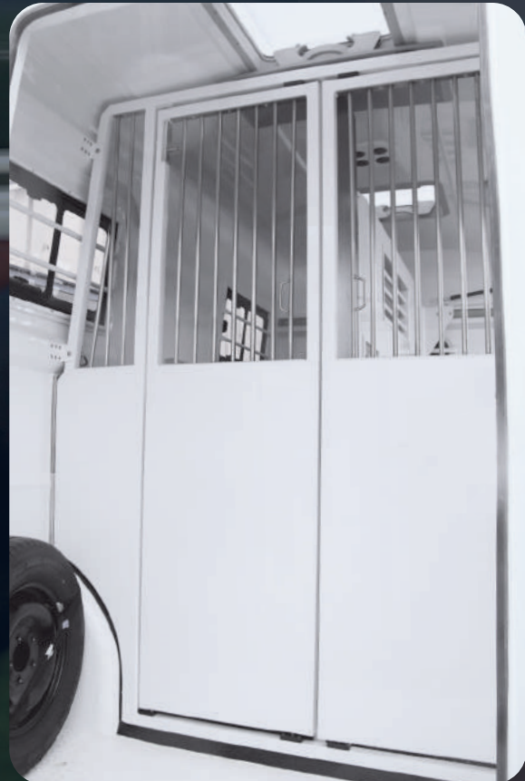
Stalles sans poteau central pour passage de malles roulantes
