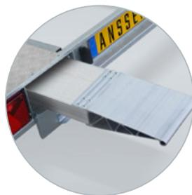
Rampes en aluminium avec rangement intégrés
