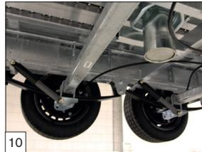
**Option :** essieux lames de ressorts paraboliques avec amortisseurs montés.
