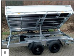
**Option :** pack „DE CHARGE“ et essieux lames de ressorts paraboliques avec amortisseurs.
